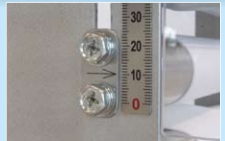
ローラ調整部にはスケールを貼付し、矢印を 刻印して、調整作業を容易にしています。
