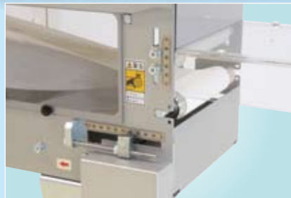
搬送物に応じて適切なローラ間隔を 設定することで安定した搬送を得られます。
